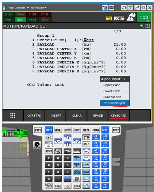
Рис. 35. Настройка Schedule No
