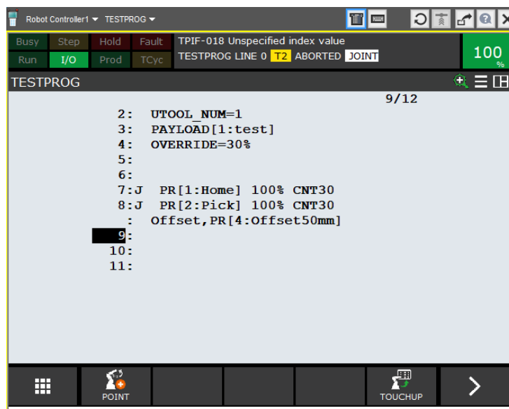
Рис. 47. Программа для перемещения манипулятора в позицию перед захватом детали
